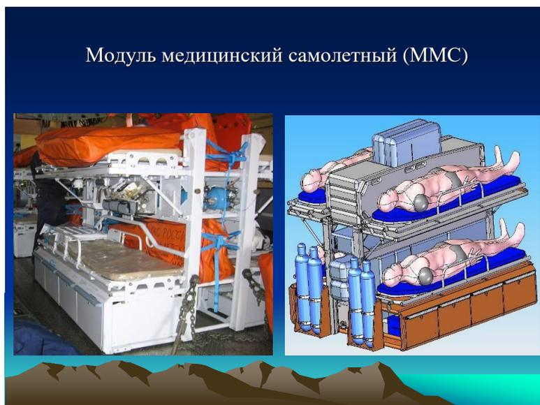
Рисунок 1. Модуль медицинский самолетный (ММС).
